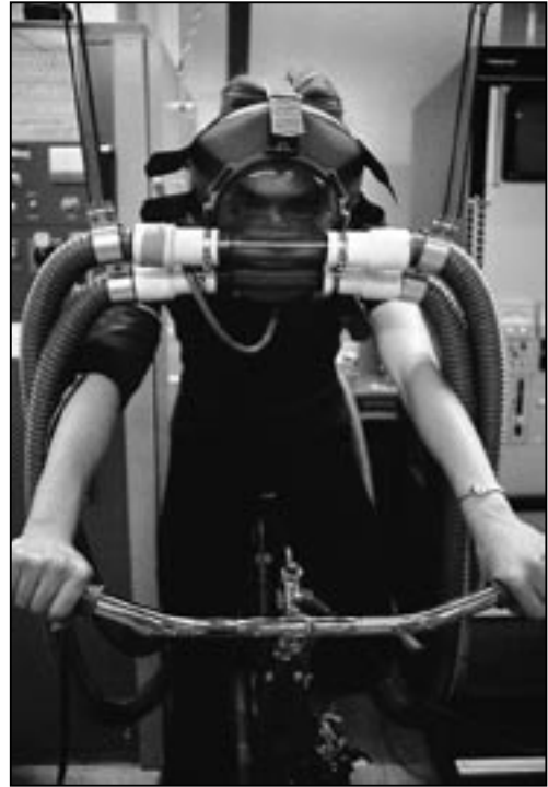
Abb. 1-20 Die Vollsichtmaske der Firma Dargatz, entwickelt in der Medizinischen Universitätsklinik Köln. Durch mehrere technische Einrichtungen konnte jede Rückatmung zuverlässig vermieden werden, selbst in höchsten Belastungsstufen mit größten Atemminutenvolumina.
